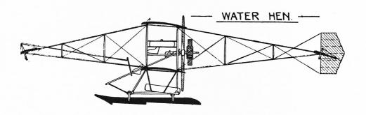
**Length.**  $-36\frac{1}{2}$  feet (11 m.) **Span.** -42 feet (12·80 m.) **Area.** -270 sq. feet (25 m.²) **Motor.** -Gnome. **Speed.** -45-33 m.p.h. (72-54 k.p.h.)
